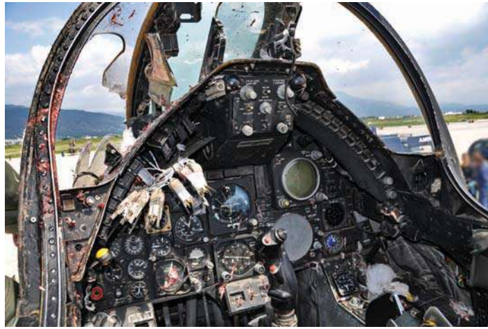
Θραύση καλύπτρας σε αεροσκάφος A-7 μετά από πρόσκρουση πτηνού.
